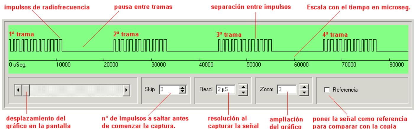
En la parte superior podemos ver el gráfico producido por la señal de un mando binario, este emite de forma continua tramas de impulsos que se repiten mientras tengamos el pulsador apretado. Cada trama se compone de impulsos anchos o estrechos que se corresponden con la configuración de los switches del mando como se puede comprobar en la imagen. Si emitimos con un mando copiador también veremos los switches aunque este no los tenga físicamente.
