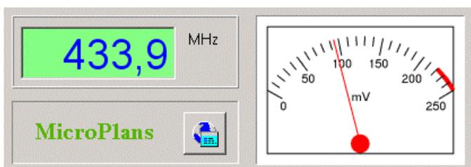
El valor de la frecuencia debe permanecer estable, si no lo está podemos mover el mando sobre la superficie del analizador hasta encontrar el sitio en el que el valor mostrado permanece constante.
